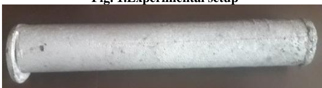
Fig. 2. Semisolid cast A319 alloy billet
