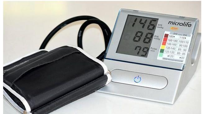
Fig.1. Digital Sphygmomanometer
