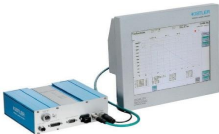
Fig. 3. Data Acquisition System – Kistler CoMo Injection
