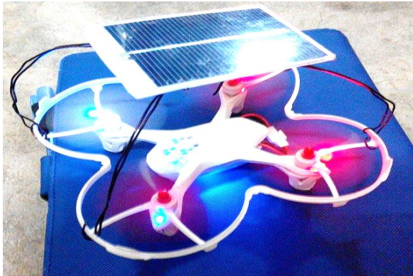
Fig. 5 The modified mini quadcopter
