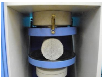
Fig. 8 Failure due to split tensile
