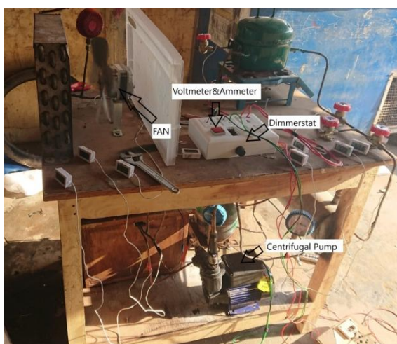
Fig. 4. Pump and Condenser Fan
