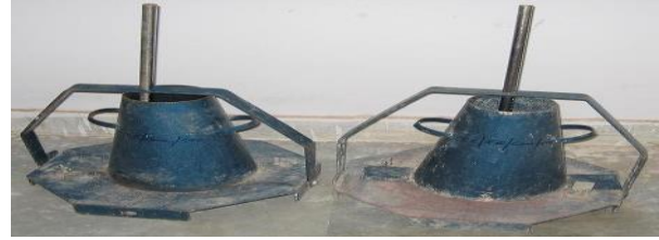
Fig. 3. Slump Test Apparatus
