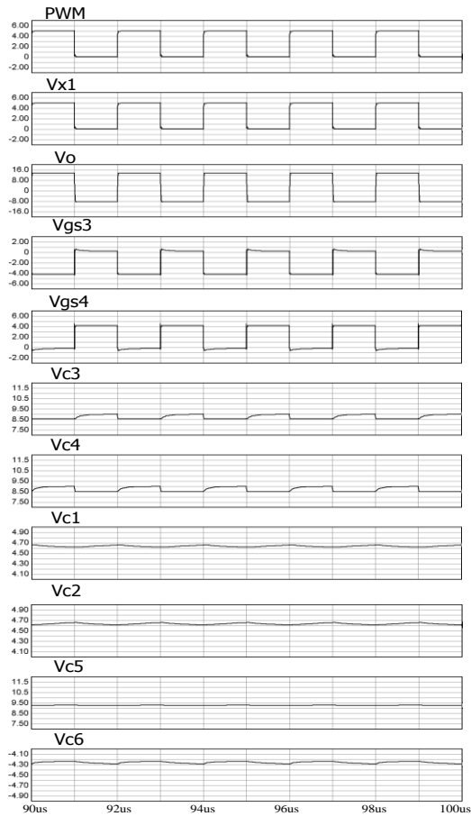
Fig. 5. Simulated results at the switching frequency of 500kHz: (1) PWM; (2) v_{X1} ; (3) v_o ; (4) v_{gs3} ; (5) v_{gs4} ; (6) v_{c3} ; (7) v_{c4} ; (8) v_{c1} ; (9) v_{c2} ; (10) v_{c5} ; (10) v_{c6} .
